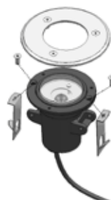
KIT SECU FIX Dispositivo anti-roubo para instalação embutida
